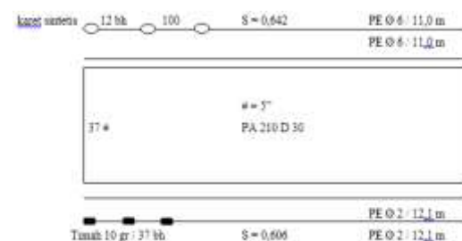
Gambar 2. Rancang Bangun Alat Tangkap Jaring Insang Dasar ukuran Mata Jaring 5 Inci
